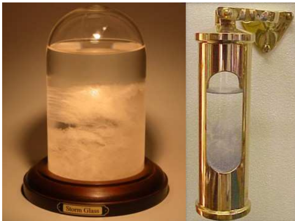
Fot. B.1. Przykłady rozwiązań współczesnych barometrów chemicznych. Źródło: internet.
