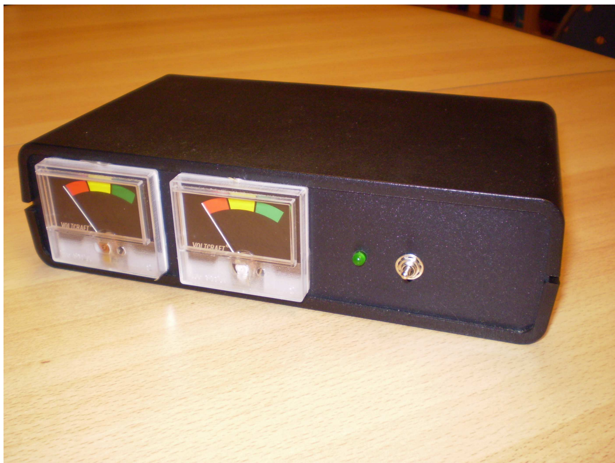
Fot. 7.3. Wygląd odbiornika, po lewej stronie wskaźnik częstotliwości, a po prawej siły impulsów
